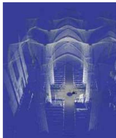
rilievo laser scanner dell'interno di una chiesa
